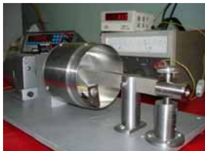
环形模板结构的焊膏可印刷性测试仪
